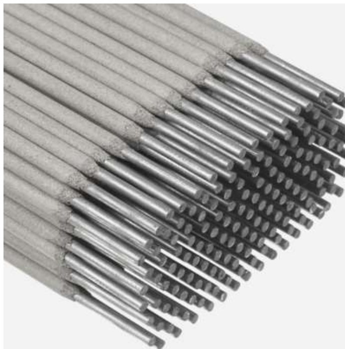
1-rasm. GOST 9466-75 bo‘yicha ishlab chiqarilgan, qalin rutil qoplamali MP-3 markali, po‘latlar va sirlarni qo‘lda yoy bilan payvandlash uchun mo‘ljallangan metall elektrodlar.
