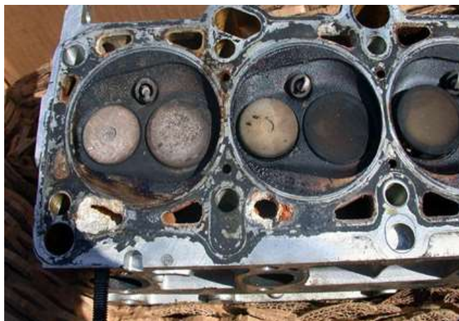
1-rasm. Dvigatelni qizish natijasida kuyishi.
