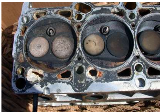
1-rasm. Dvigatelni qizish natijasida kuyishi.
