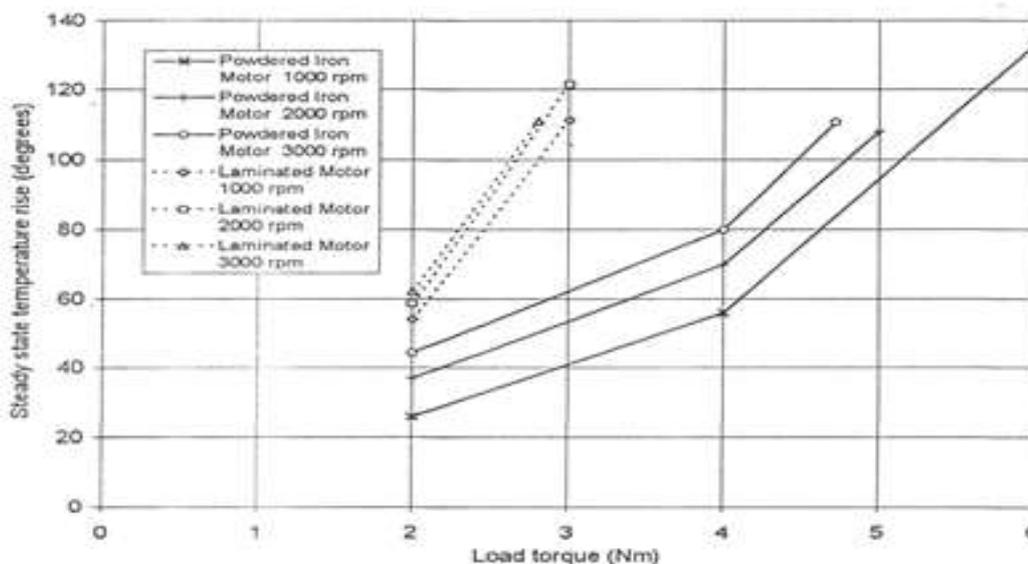
Рисунок 6. – Результаты сравнения нагрева магнитопроводов на основе нового композиционного материала и с использованием электротехнической стали в зависимости от крутящего момента
