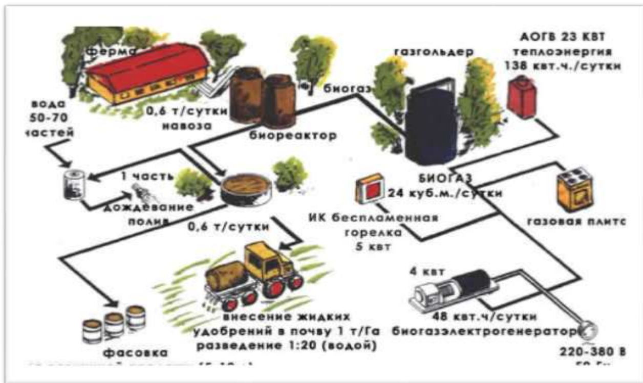
1-Rasm. Ushbu rasmda mahalliy homashyolardan suyuq o'g'it olish jarayonida ishtirok etadigan barcha texnologiyalar aks etgan.
