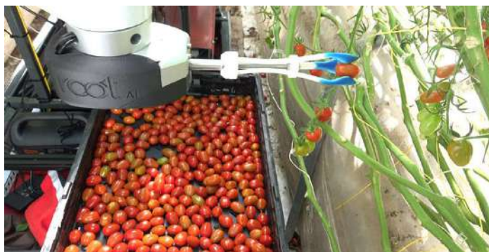
Рис.4. Робот с автоматическим управлением Virgo-1 в деле по сбору помидоров.
