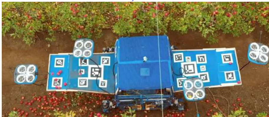
Рис.1 Летающие квадрокоптеры с прикрепленной вытянутой рукой,
