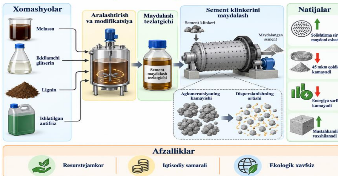
1-rasm. Mahalliy va ikkilamchi xomashyolar asosida sement maydalagichlarini olish sxemasi.
