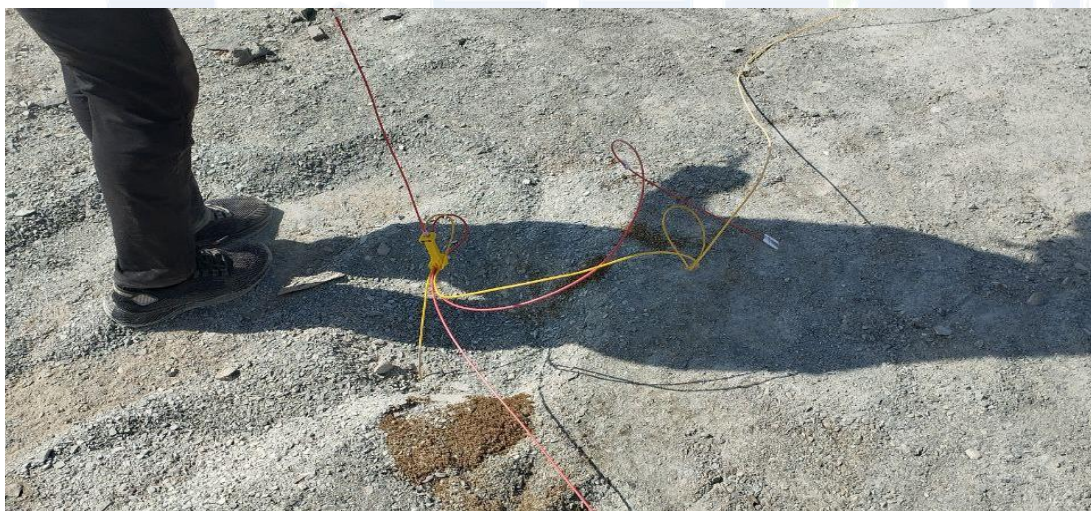
2-rasm. Portlatishdan oldin «KORSHUN-M» elektrsiz initsiyalaydigan vositasi bilan «ISKRA-S» elektrsiz initsiyalash vositasining skvajinadan chiqqan qismlarining bir-biriga ulanish jarayoni
