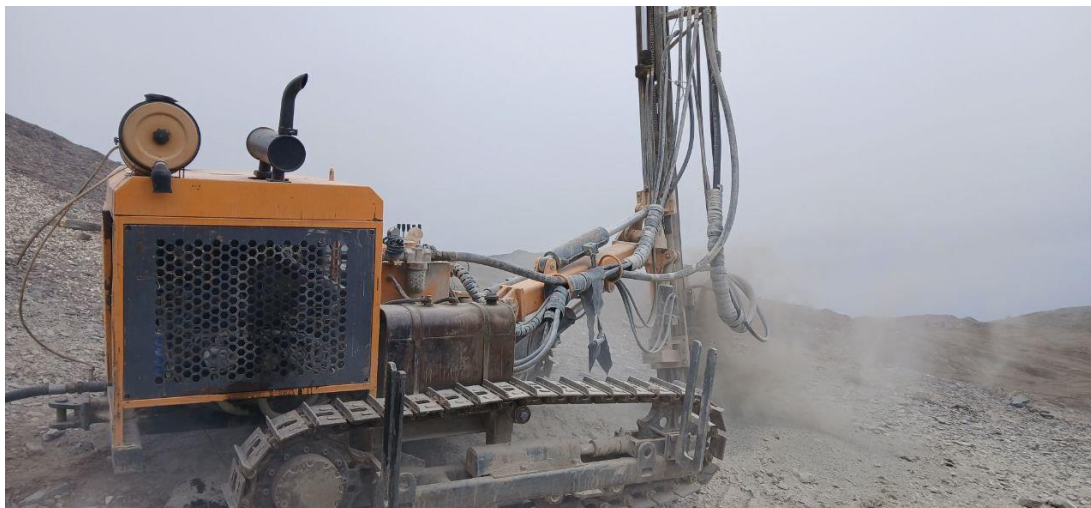
1-rasm. «Kaishan» rusumli burg'ulash stanogi bilan noruda qurilish materiallari karerida burg'ulash jarayoni
