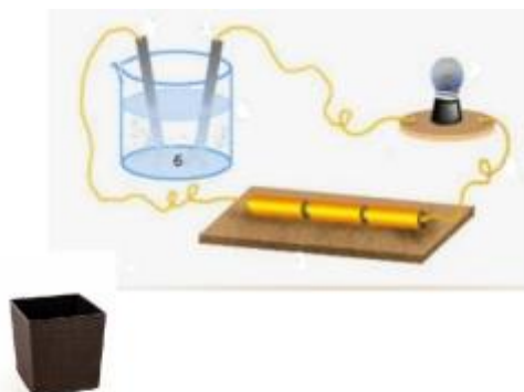
3 - rasm. Elektrolit va noelektrolitga ajratuvchi asbobni yasash jarayoni
