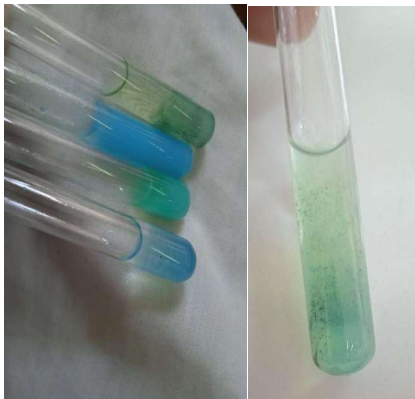
2-rasm. Mureksid bilan mis (II) ionlarining turli konsentratsiyalardagi reaksiyalari
