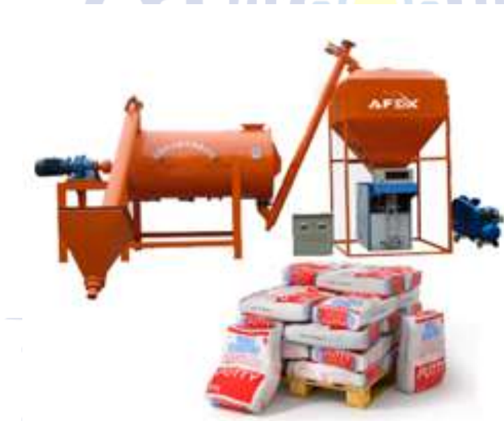
2 - rasm. Gips asosidagi quruq qurilish qorishmasi ya’ni shtukaturka ishlab chiqarish uchun uskuna.
