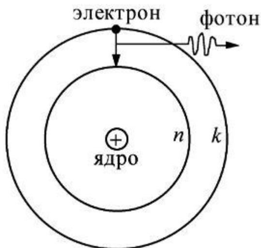
*Излучение или поглощение кванта излучения происходит при переходе атома из одного стационарного состояния в другое*
