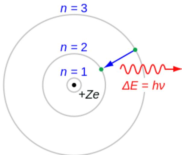
Боровская модель водородоподобного атома ( $Z$  — заряд ядра), где отрицательно заряженный электрон заключен в атомной оболочке, окружающей малое, положительно заряженное атомное ядро. Переход электрона с орбиты на орбиту сопровождается излучением или поглощением кванта электромагнитной энергии ( $h\nu$ ).
