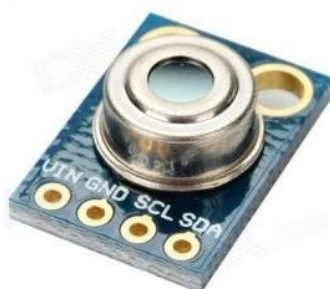
Рис.2. Инфракрасный датчик MLX90614
