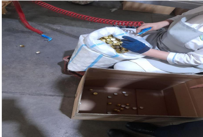
1-rasm. Qopqoqlarni qo‘lda mexanik usulda tozalash
